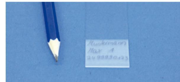
Abb. 5: Optimale Beschriftung des Objektträgers mit Bleistift
